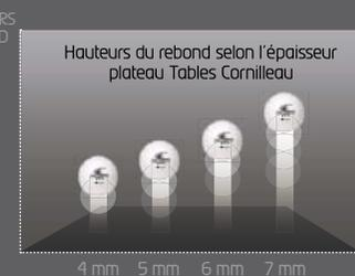
Les panneaux en résine (stratifié massif) résistent aux coups de raquettes. Plus le panneau est épais (de 4 à 7 mm), meilleur est le rebond.
